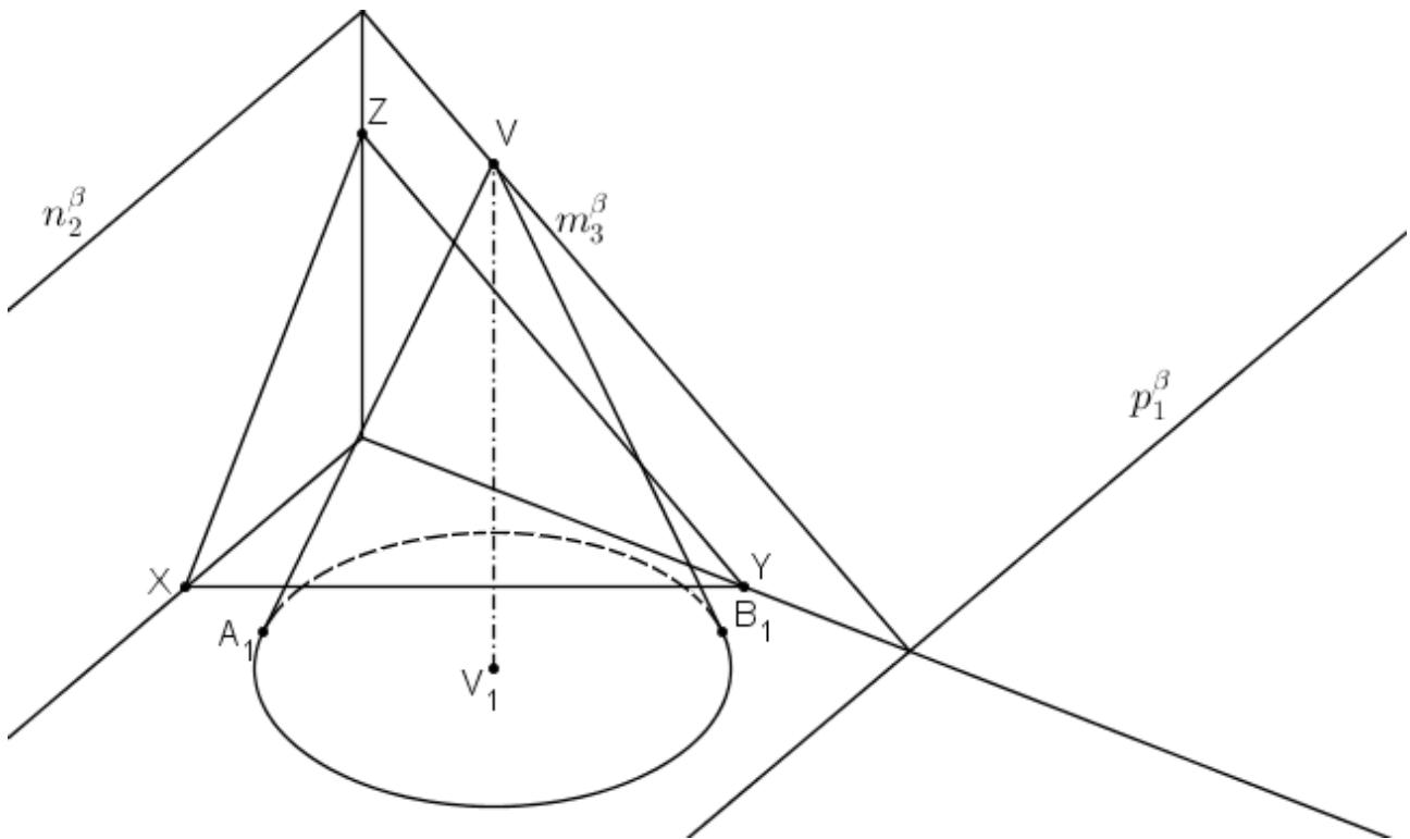
2) Sestrojte řez rotačním kuželem s vrcholem  $V$ . Rovina řezu  $\rho$  je určena svými stopami.
