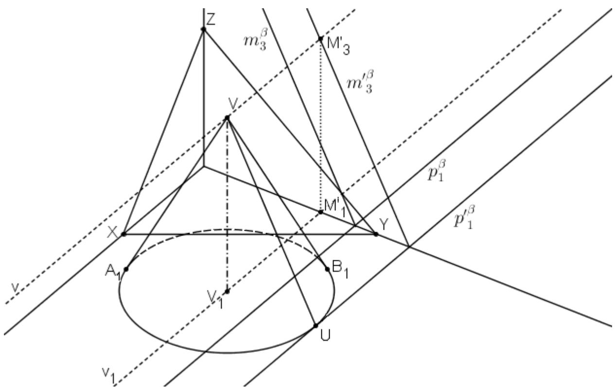
3) Sestrojte řez rotačním kuželem s vrcholem  $V$ . Rovina řezu  $\rho$  je určena svými stopami.
