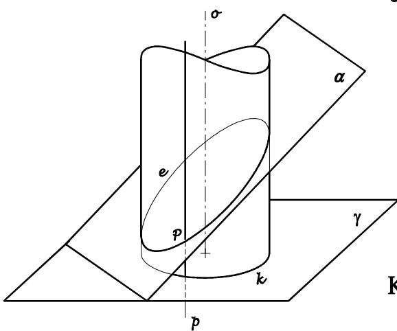
dáno - rotační válcová plocha s řídící kružnicí  $e$  v rovině  $\gamma$
