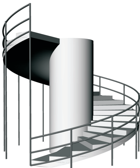
Obrázek 8: Přímý šroubový konoid jako spodní část točitého schodiště.
