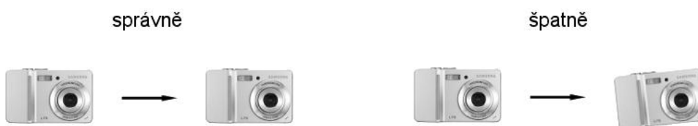
Obr. 58 Nežádoucí rotace fotoaparátu mezi dvěma snímky.
